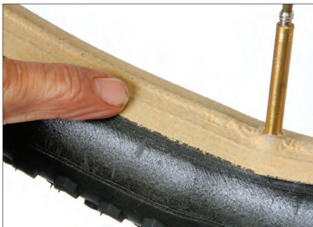
La colla va qui: la fascia di incollaggio al cerchio è a sua volta incollata alla carcassa e ricopre il cordone di cucitura di sigillatura del tubolare stesso.
