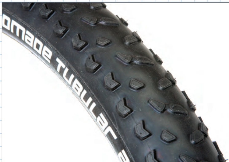
GEAX Barro Race: oltre al Saguaro da 630 g, Geax propone in versione tubolare anche l'apprezzato, in ambito agonistico, Barro Race con sezione 2.0" e peso di soli 590 g (comprende infatti anche la camera d'aria al proprio interno). La costruzione utilizza una carcassa da 290 fili per pollice ed una mescola 50a.
